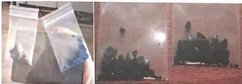
7 Сурет – Пластина түріндегі магнетит дәндері
