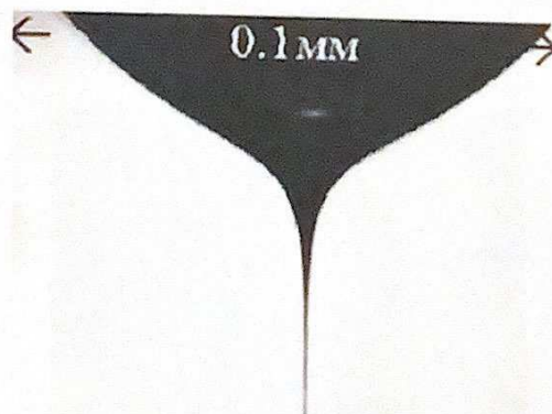
4.1 Сурет – Бастапқы ағынды қалыптастыру кезінде Тейлор конусының пайда болуы [19]
